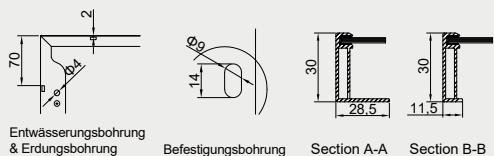
Entwässerungsbohrung & Erdbohrung
